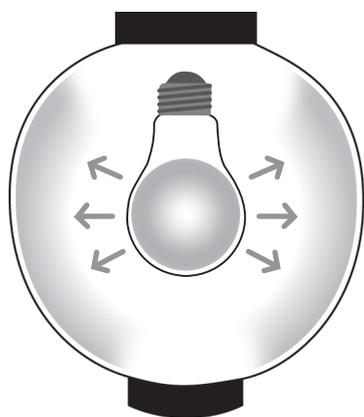
弊社製品は、LEDを横配列することにより、真下方向の光を小さくして側面への照射が重要な提灯に適しています。
